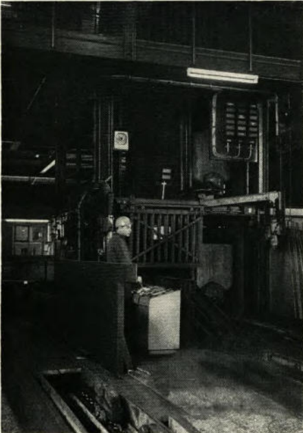
Zwei Anschläger – einer untertage im Kommandostand und einer übertage vor dem Steuertisch – auf unserem Bild ist es Ludwig Schmelzer – steuern mit Knopfdruck die Förderkörbe im Hansenschacht. In zwei Förder-schichten täglich bringen sie 4700 Tonnen Rohkohle in etwa 1500 Förderwagen ans Tageslicht
