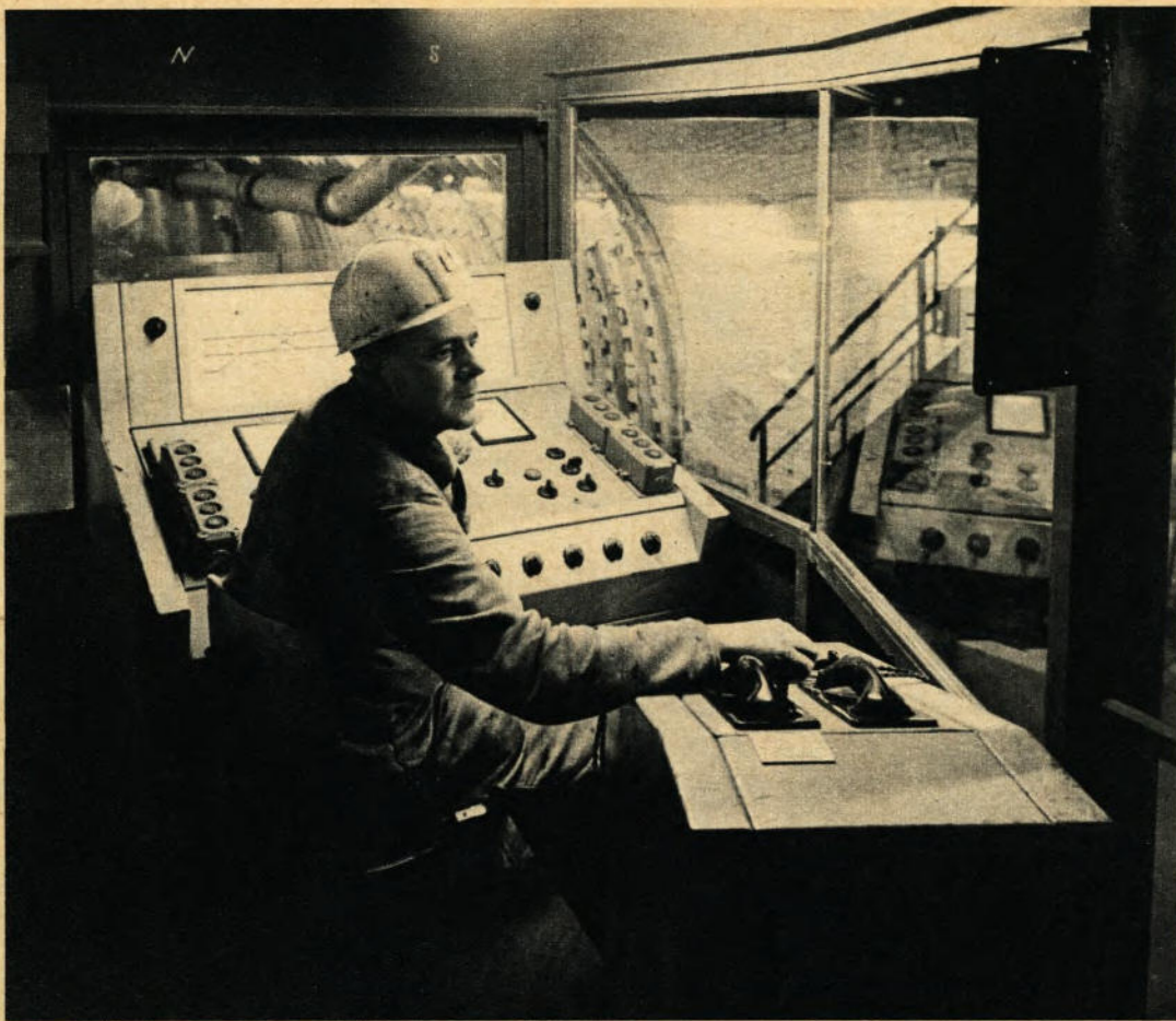
▲ Früher gab der Anschläger am Schacht stehend seine Signale nach oben, heute „besichtigt“ er von dieser Kanzel aus den Förderkorb; viele Einzelvorgänge laufen dabei automatisch ab
