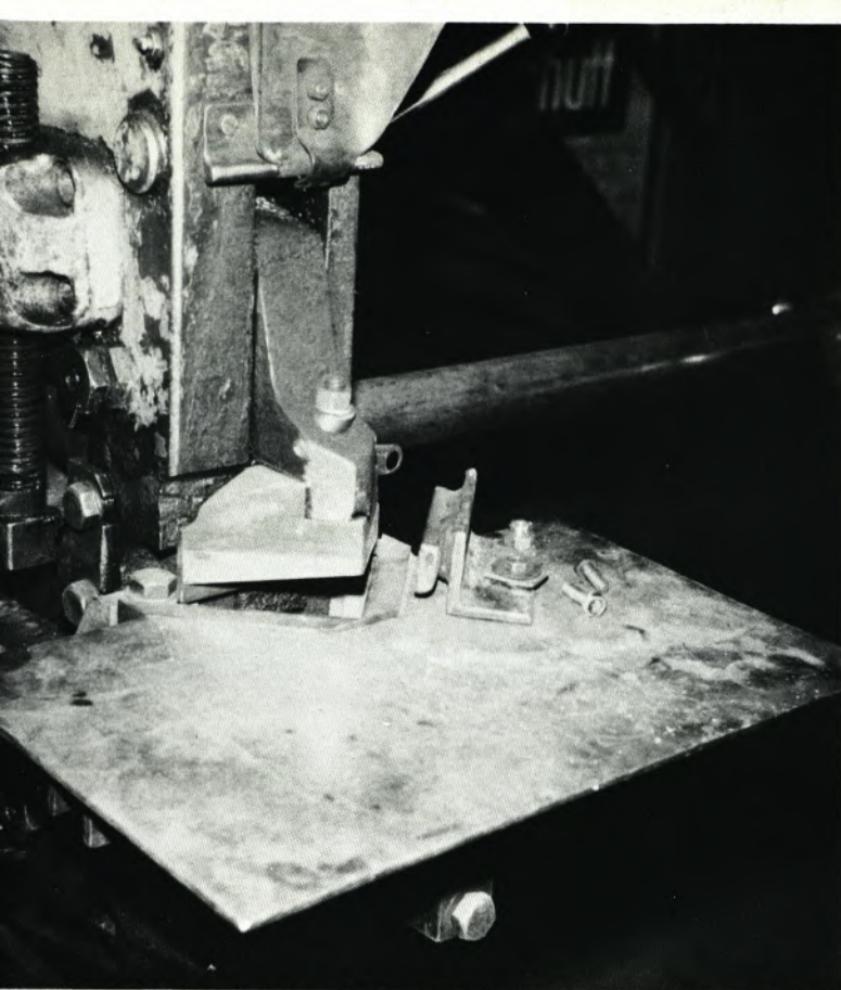
Bild 5 u. 6 Eine von Günter Schmidt erdachte Schablone (Bild 5) ermöglicht maßgenaues Schneiden von Zettelhalterbügeln auf der Profilschere (Bild 6, mit Werkstück)
