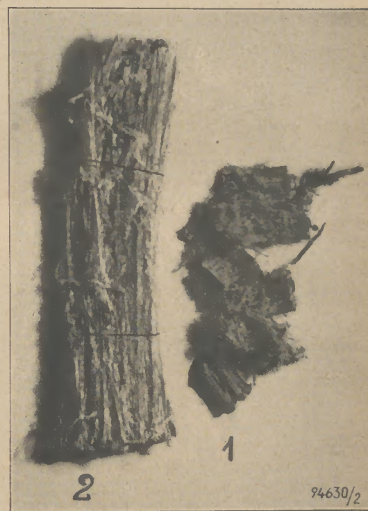
Abb. 4: Blauer Asbest (1), gelblich-brauner Asbest (2)
