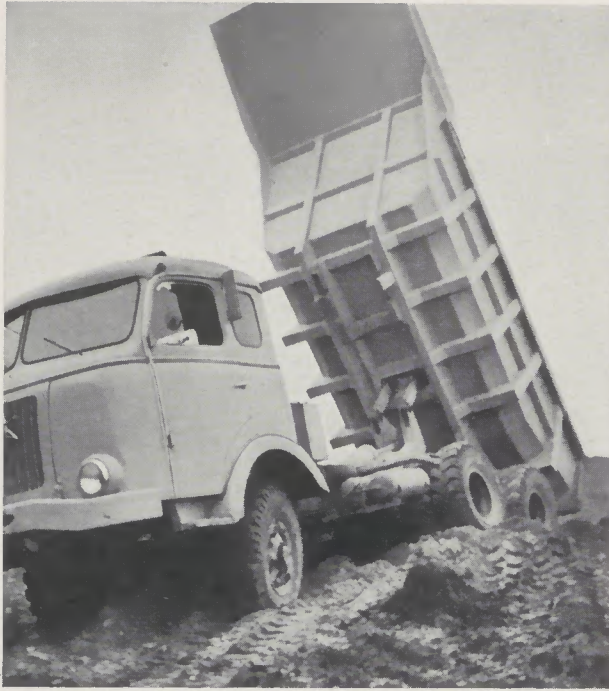
Die große Verschränkung der Achsen wird allen Gelände-Verhältnissen gerecht.
