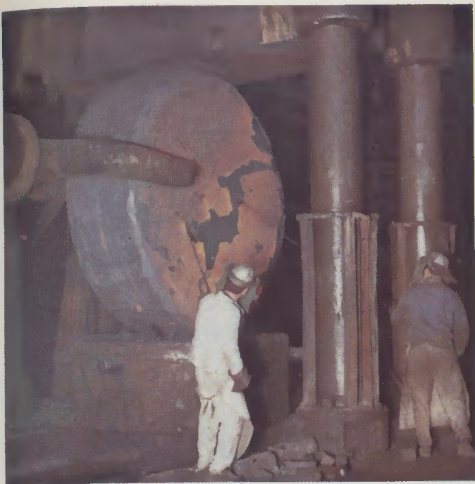
Schmieden eines Dampferzeuger-Rohrbodens aus Reaktorstahl 22 NiMoCr 37 mit einer vorgeschriebenen Warmstreckgrenze von 35 kp/mm 2 bei 350° C.
