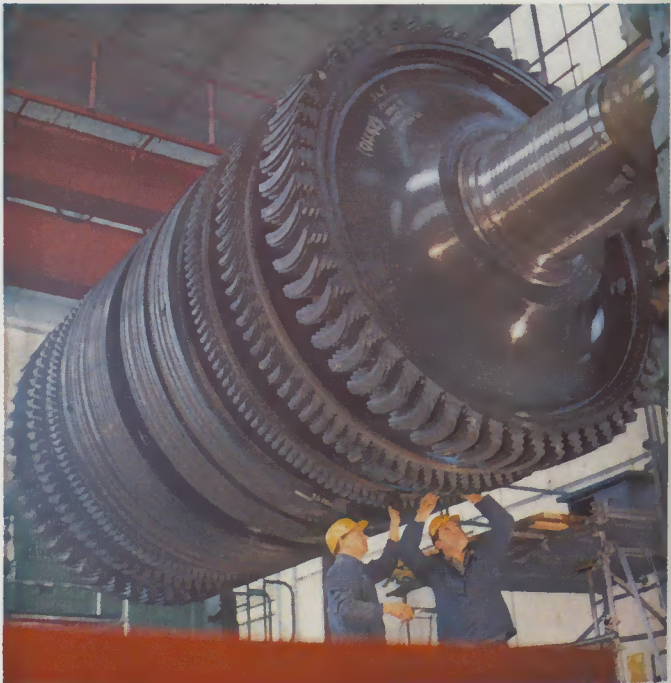
Montage einer 1500tourigen Niederdruckturbinenwelle im Werk Mülheim der Kraftwerk Union AG. Die Welle und die Scheiben wurden aus Werkstoff 25NiCrMoV 14 5 hergestellt.
