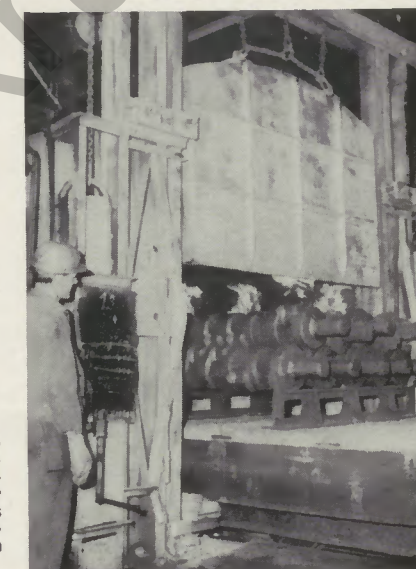
Das Vergüten schwerer, gesenkschmiedeter Kurbelwellen erfordert viel Sorgfalt. Hier fährt der Glüher und Anlasser Willy Buss einen Herdwagen mit Kurbelwellen zum Härten in den Ofen.
