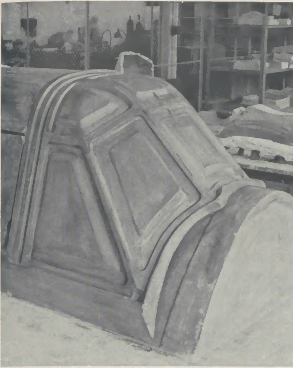
Von dem Gipsmodell der Führerraumabdeckung (Abb. 11) wird ein Negativ abgenommen, das in Sand eingegossen (Abb. 1, Mitte), in Magnesium abgegossen und bearbeitet wird. Abb. 12 zeigt das in dem so entstandenen Elektron-Gesenk gepreßte Fertigteil
