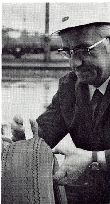
Der Ruhrorter Arbeitsschutz hat seine Mitarbeiter und die Sicherheitsobleute mit Profil-Prüfgeräten ausgerüstet: Hier Sicherheitsmeister Pape bei der Kontrolle eines Reifens, der offensichtlich mit zu hohem Luftdruck gefahren wurde; nur die Mitte ist abgenutzt
