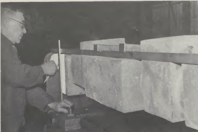
Bild 1: Anreißer Alfred Heidmann mißt einen Rohling aus und reißt die Lagerstellen sowie die Hubstellung an.
