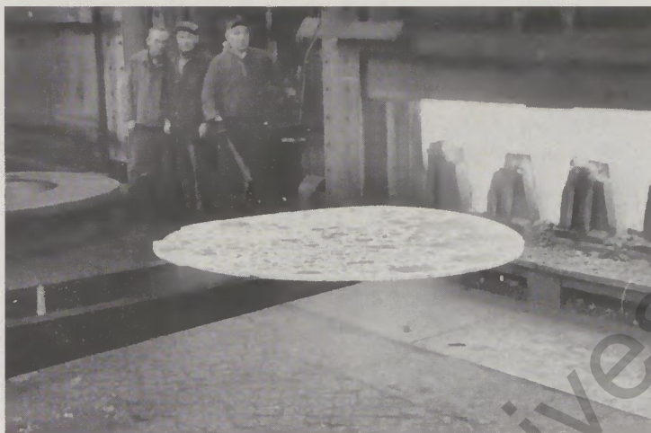
Ein Manipulator bewegt ein glühendes Blech, das als Heizmantelboden im Mischerbau verwendet werden wird, vom Ofen zur Kumpelpresse.
