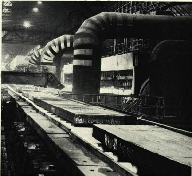
Brammen werden auf elektrisch angetriebenen Rollen transportiert.
