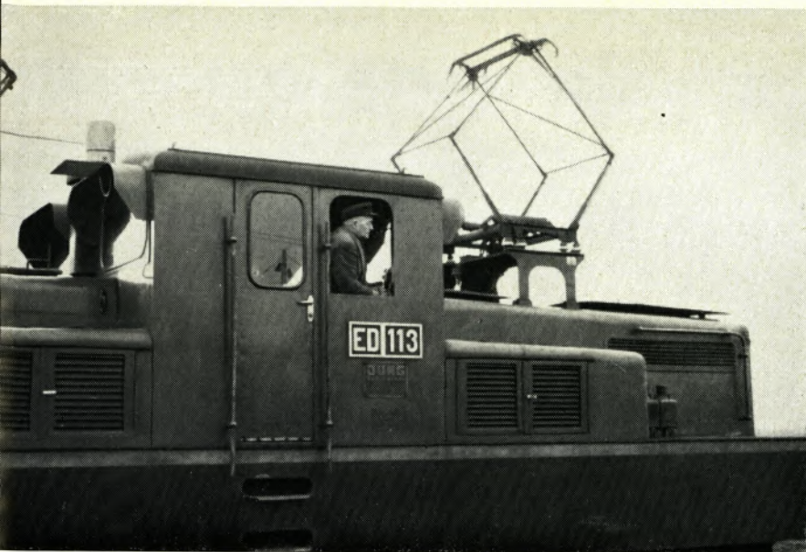
ED 113, eine unserer bereits mit Rangierfunk ausgerüsteten Lokomotiven mit Lokführer Schlebusch. Oben links ist die Antenne zu erkennen.
