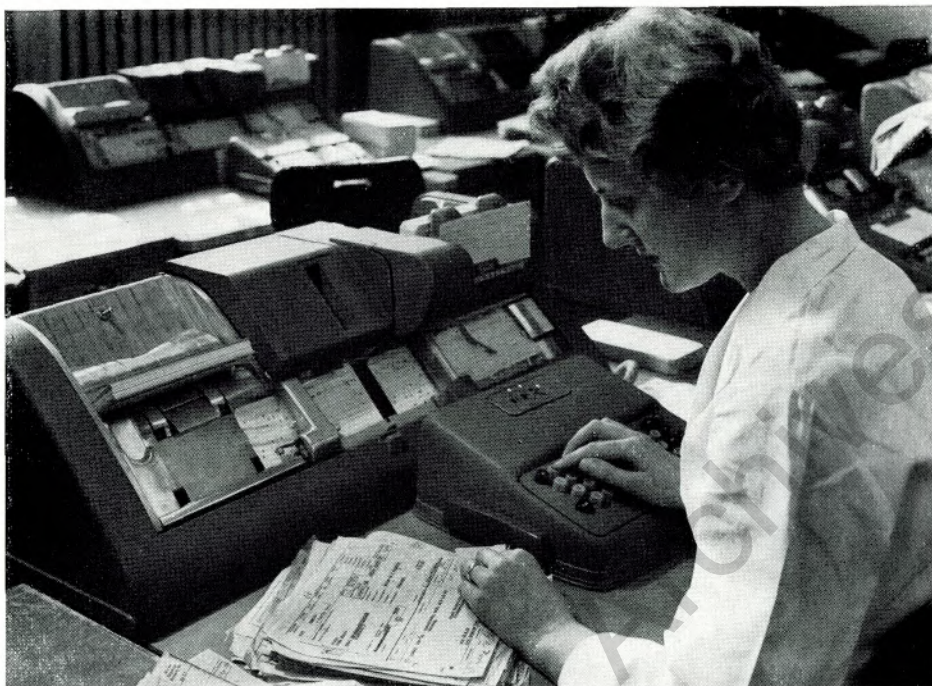
Die Maschine, die von zarter Frauenhand in der Lochkarten-Abteilung unserer Hütte bedient wird, ist ein Schreibblocher 026. Hier werden gerade Wareneingänge bearbeitet
