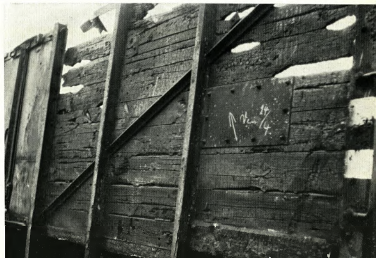
Nicht „profilfreie“ Gleise rufen immer wieder Zerstörungen hervor, wie verbogene Fußtritte, abgerissene Seitenwandungen und abgeschlagene Seillösen.
