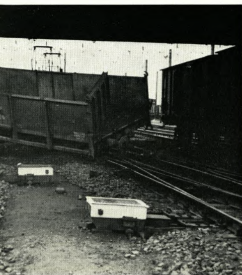
Fahren beschädigter O-Wagen, unter dem die Weiche während der Fahrt umgelegt wurde.
