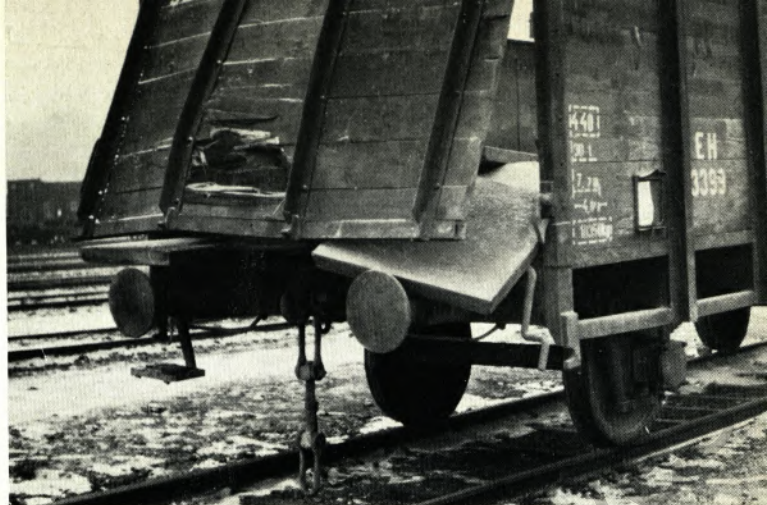
Hier hat die Ladung beim Auflauf die Kopklappe eines O-Wagens zerschlagen.
