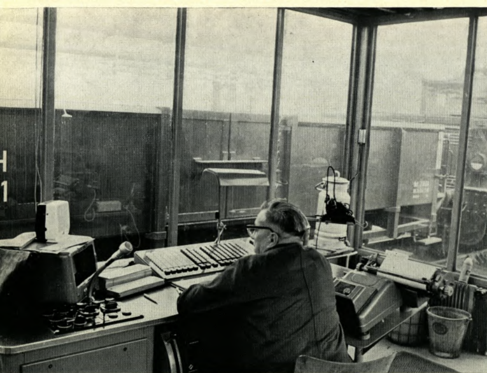
Eine sehr wichtige Einrichtung auf dem Bahnhof Meerbergstraße ist die Doppelwaage. Auf ihr können alle nach dem Werk II oder von dort kommenden Wagenladungen gewichtsmäßig erfaßt werden
