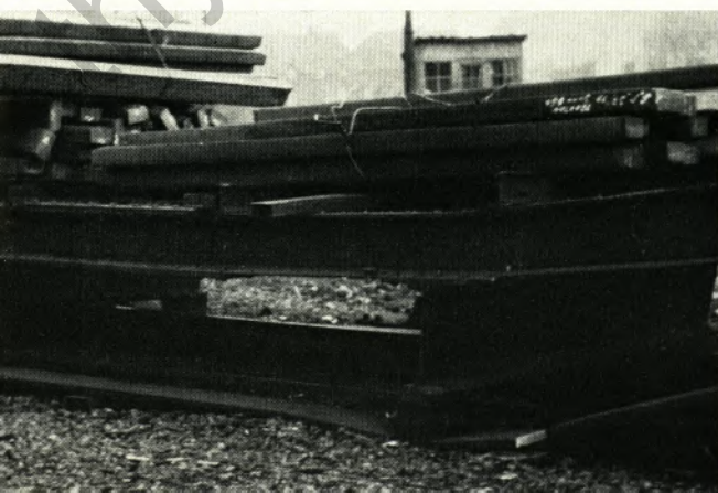
Nachdem die schweren Lasten zunächst richtig auf die Kopfenden über die Drehgestelle verteilt wurden, zwang eine nachträglich in der Mitte abgesetzte Überlast den Wagen „in die Knie“.
