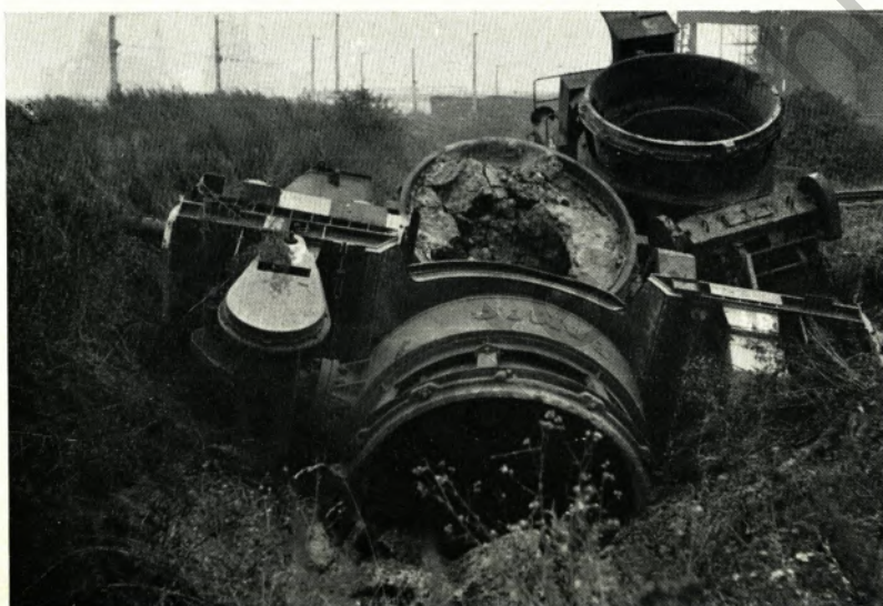
Beim „Durchrutschen“ über das Gleisende gedrückte und beschädigte Pfannenwagen.
