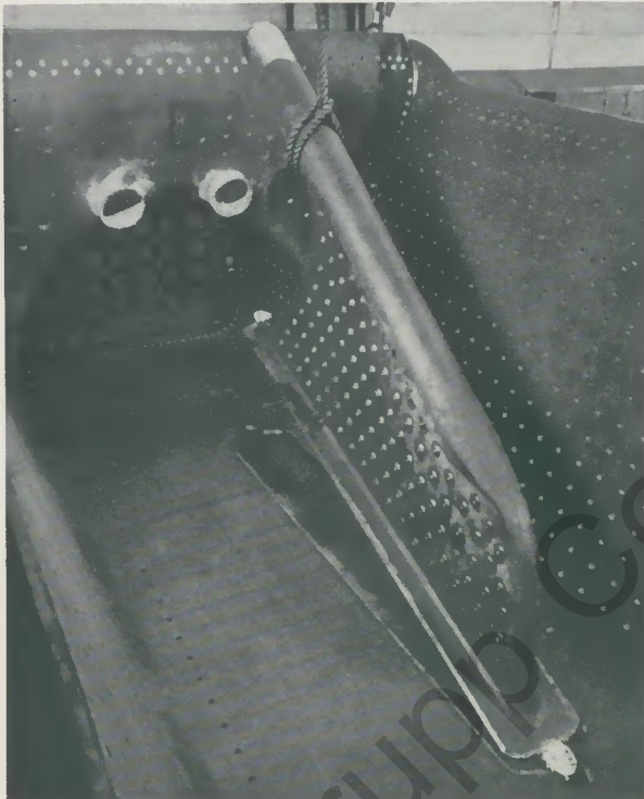
14 Einpassen der Wasserkammer in die Feuerbüchse
