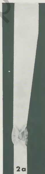
2a Schnitt und Grobgefügebild der Schweißnaht zwischen Ober- und Unterteil einer Rohrwand.
