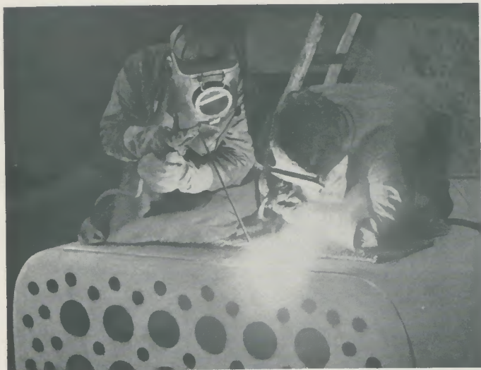
6 Schweißen der Feuerbüchse-Decke
