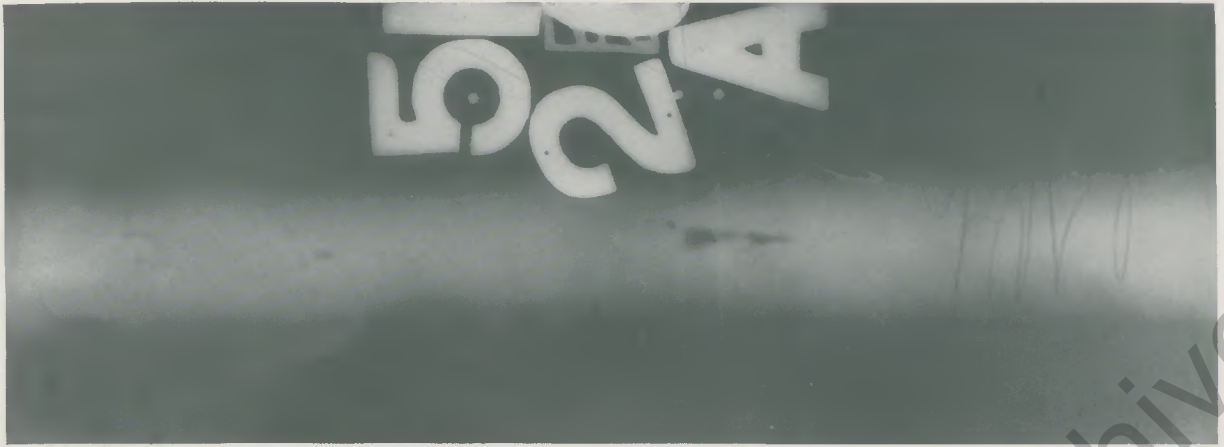
12a Rundungsnaht mit Schlacken-Einschlüssen
