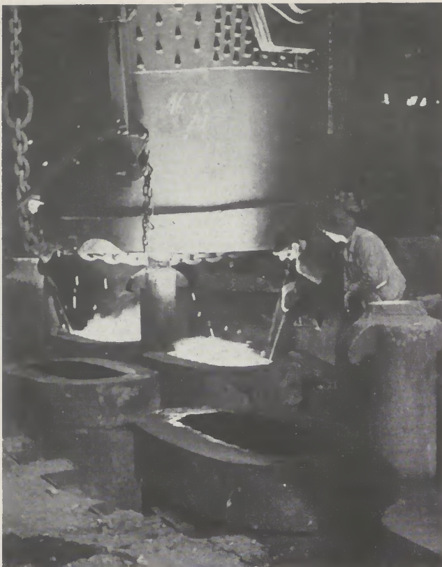
Kokillenguß: Beim steigenden Guß (unser Bild) steigt der Stahl — auf dem Umweg über einen Trichter und kleine Kanäle — von unten in den Kokillen hoch
