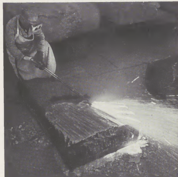
Der Flämmer: Durch das Abflämmen der Brammen erhält man das Vormaterial für Bleche besonderer Qualität
