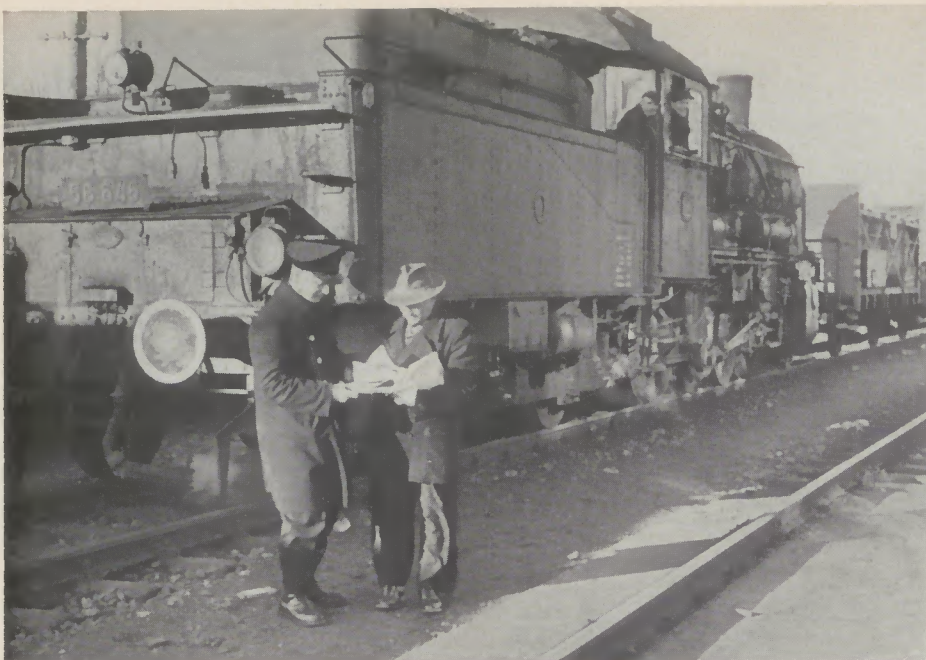
...über die Einfahrtsweiche schiebt sich die schwere Lok der Bundesbahn auf das Zustellgleis im Werksgelände. Wenn die Übergabe (die auf unserem Bild Werkmeister Biesemann vornimmt) beendet ist, wird die Bundesbahnlok abgekoppelt und erhält freie Fahrt zum Umsetzen...
