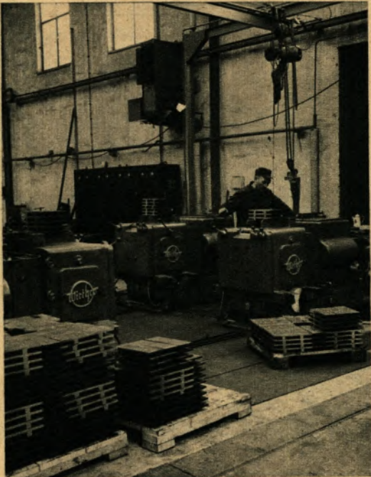
▲ Walter Ischebeck an einem der Automaten, mit denen Weichenrippenplatten gefräst werden ◀ In der neuen Werkhalle III der Dörken AG fräst Günter Busch Rippenplatten
