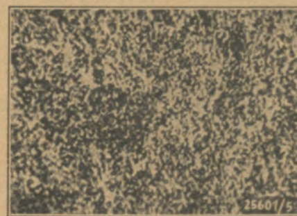
Abb. 20: Derselbe Werkstoff, weichgeglüht (1000fache Vergrößerung)
