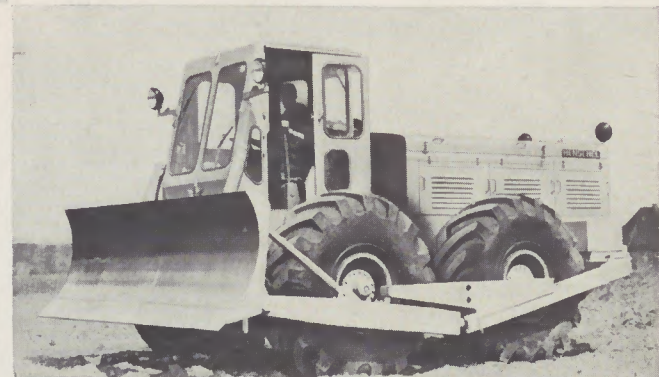
HENSCHEL-Räumer und Planiergerät R 300 mit 6-Zylinder Turbolader-Henschel-Dieselmotor, 305 PS. Bisherige Bilder zeigten den R 300 beim Erde-abtragen, beim Planieren, beim Gleisrücken, beim Schleppen schwerer Lasten. Die Maschine ist durch sorgfältige Entwicklung für viele Arbeiten das richtige Gerät.
