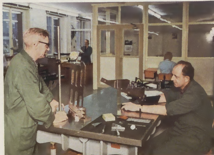
Abb. 7 Lösen von Meßaufgaben unter Verwendung von Endmaßen und Meßuhren auf der Kontrollplatte
