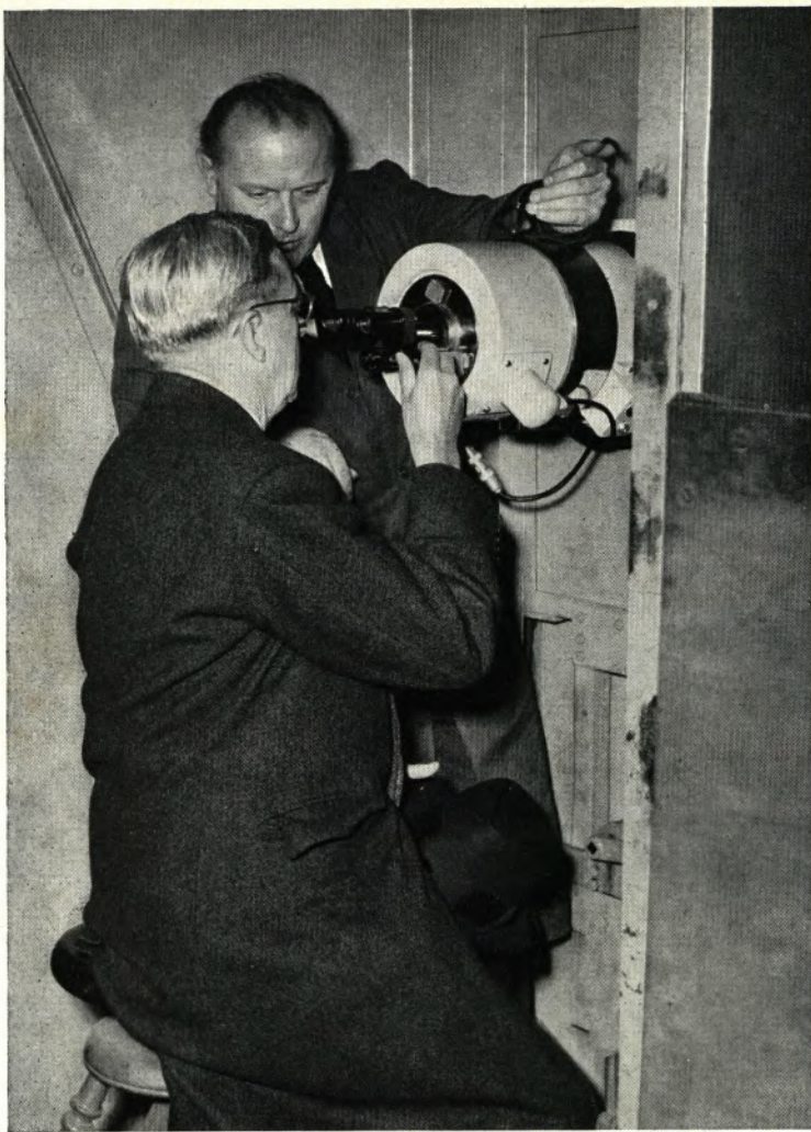
1 m Schweißnaht in der Minute können mit dem neuen Bildumwandler der Röntgenabteilung in Mülheim untersucht werden, ohne daß ein Röntgenfilm gemacht zu werden braucht. Beim Besuch in Mülheim nimmt US-Botschafter Dr. Conant ein Rohr „unter die Lupe“
