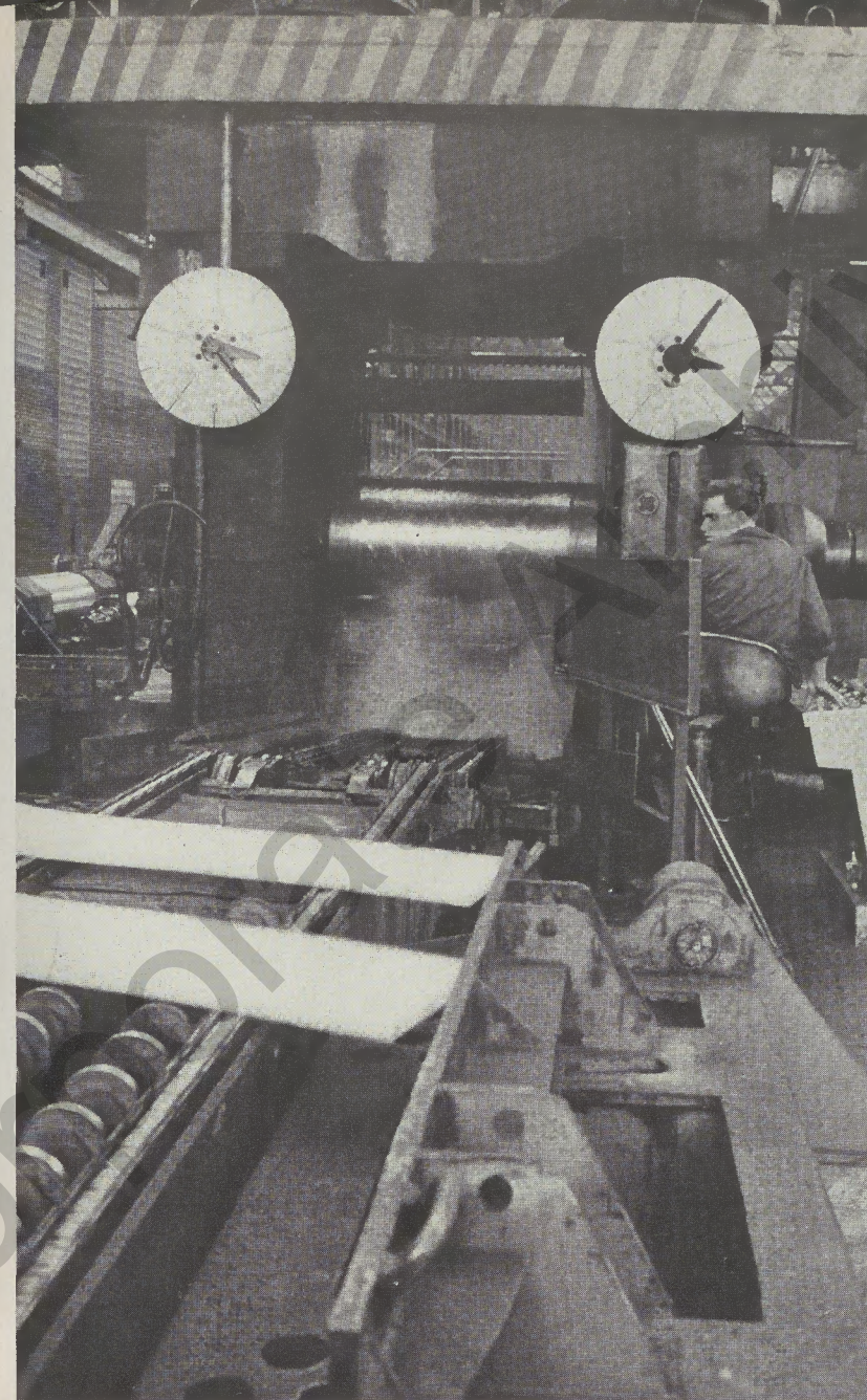
Vor zwei Jahren geliefert: ein Feinblech-Walzwerk (oben: das Trio-Vorgerüst)
