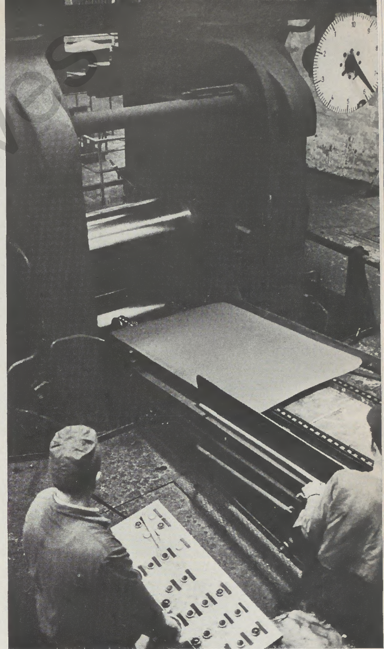
Blick auf eines der zwei Duo-Fertigerüste
