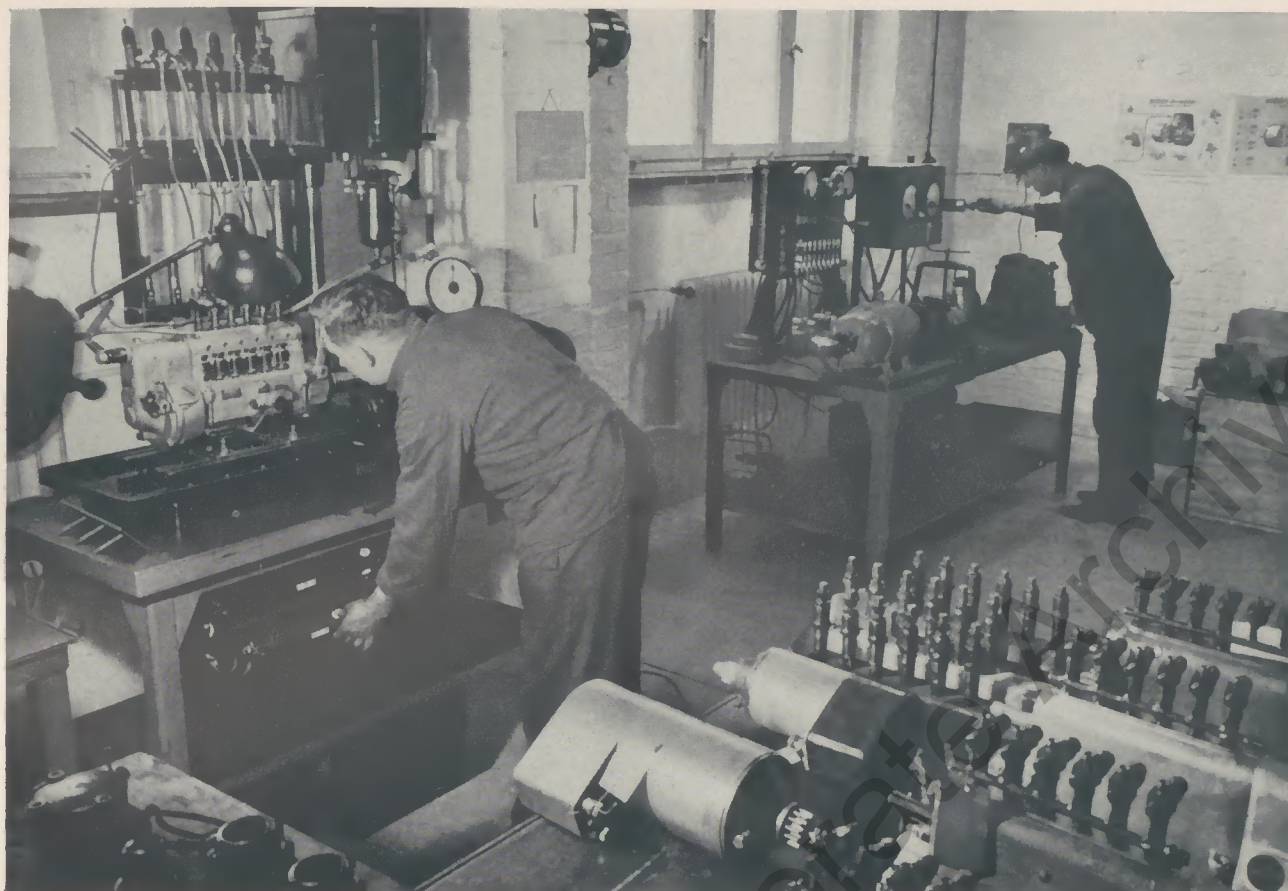
Pumpenprüfstand und Zündanlagenprüfstand
