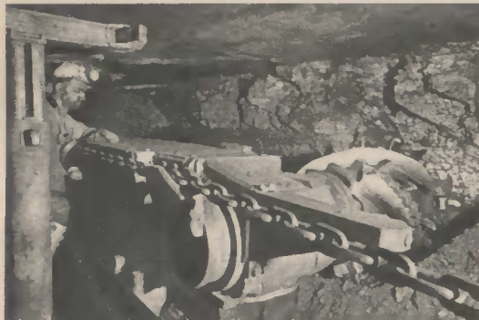
▲ In den letzten Jahren hat sich die Elektrizität als wichtigster Energieträger auch unter Tage durchgesetzt. Ein Beispiel dafür ist der abgebildete Walzenschrämlader, der die Kohle aus dem Kohlenstoß löst und auf das Fördermittel wirft
