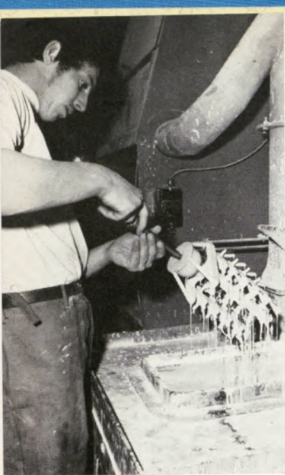
Unser Mitarbeiter Werner Manfeld umhüllt die Traube durch Eintauchen in eine Keramikmasse mit einem ersten feuerfesten Überzug, der einen Mantel aus feinem Sand erhält (rechts oben).
