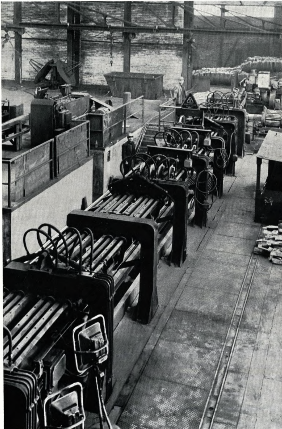
Die modernste Anlage in der Torstahlhalle des Streck- und Drillbetriebs der Niederrheinischen Hütte in Duisburg-Hochfeld ist die kombinierte vierköpfige Streck- und Drillmaschine.
