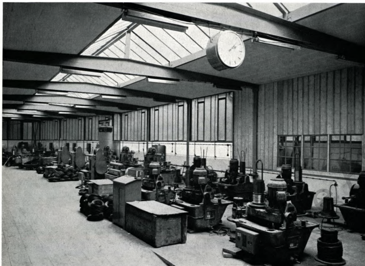
Der neue Kratzenzug. Hier werden auf mehr als dreißig Maschinen hochwertige Stahldrähte in den verschiedensten Abmessungen gezogen.
