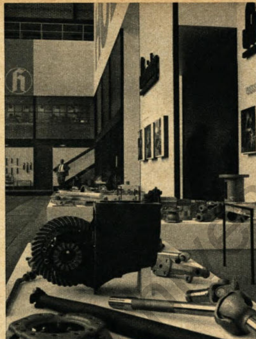
▲ Die Vielzahl von Schmiede- und Gußstücken, die die Schmiedag für das Automobil liefert, reichen von Pleuelstangen und Kurbelwellen bis zu Achsgehäusen und Bremstrommeln
