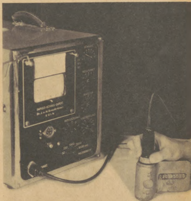
Prüfung eines Stahlgußteiles mit Ultraschall
