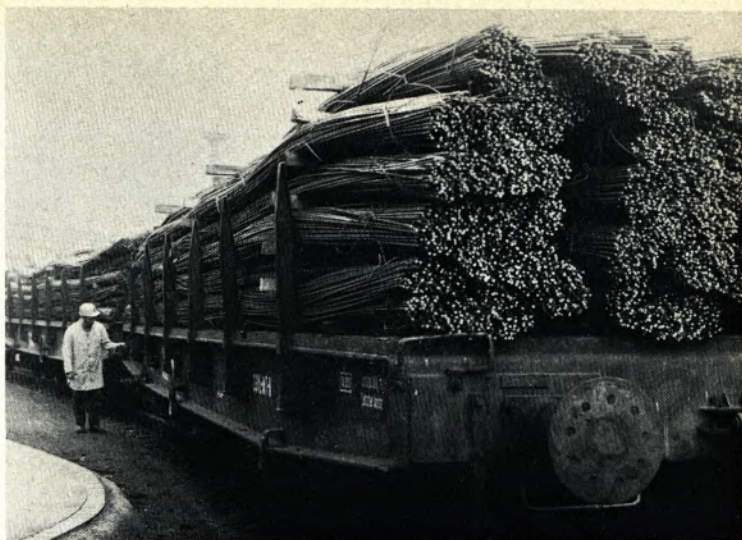
Bild links: Materialfluß Straße: Lieferung von Knüppel mittels Sattelschlepper. Bild rechts: Übergang von Materialfluß Schiene auf Materialfluß Schiff. Diese Werkswaggons mit je 120 Tonnen Torstahl (verdrillter Walzdraht) sind auf dem Wege zum Rheinkai, wo das Material auf Schiffe umgeschlagen wird. Bild unten: Materialfluß Schiene oder Straße: Draht, der keiner Witterung ausgesetzt werden darf, wird in gedeckten Wagen oder Behältern (Bild) transportiert.
