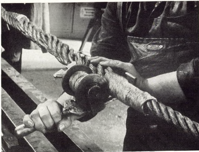
Die Spleißung ist abgeschlossen. An der Spleißstelle erhält sie eine Schutzumwicklung
