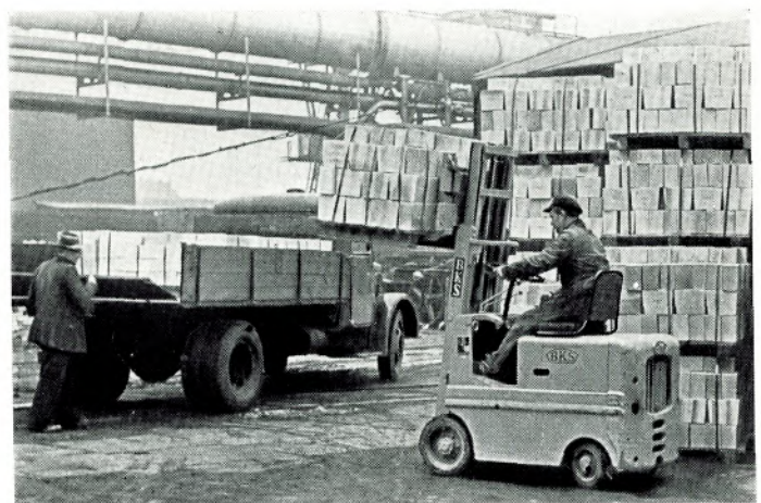
Gabelstapler im Einsatz in der ff. Steinfabrik
