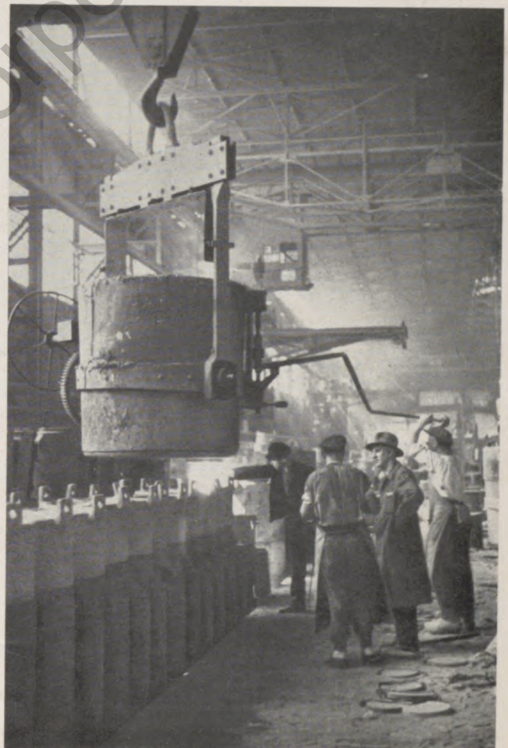
Bild 4: Abgießen des Elektrostahles aus der Pfanne in die Kokille
