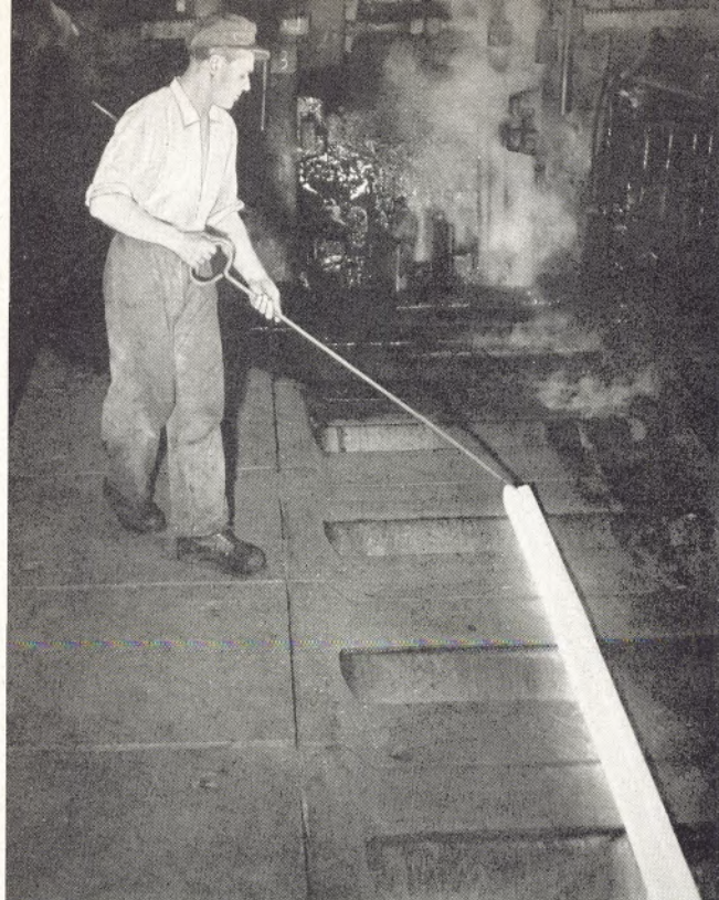
Auf der Straße V unserer Hütte: Walzer Franz Holdak beim Auswalzen eines Knüppels zu einer leichten Schiene
