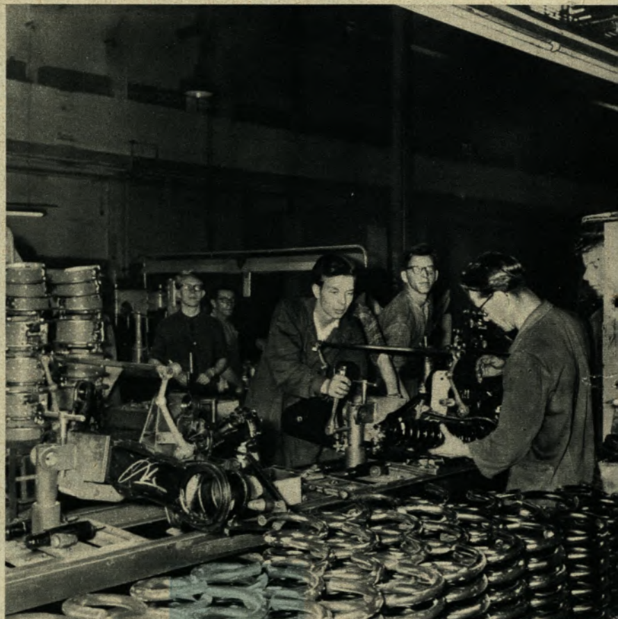
Bei der Federmontage für die „Isabella“ im Bremer Werk der C.F.W. Borgward GmbH.
