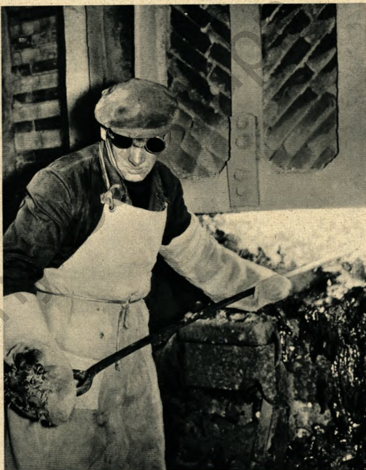
Entnahme einer Stahlprobe
