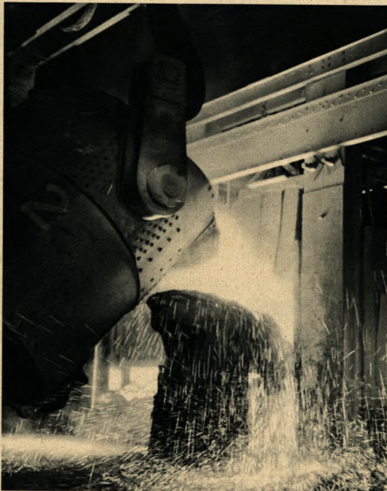
Füllen eines SM-Ofens mit flüssigem Einsatz
