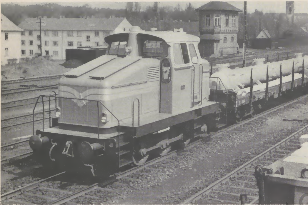
Dieselhydraulische Henschel-Lokomotive Typ DH 500, ausgerüstet mit dem 12 V 1416 A Henschel-Dieselmotor, Motorleistung 500 PS bei 1800 U/min. Die Lokomotive ist bei den Rheinstahl Eisenwerken in Mühlheim-Meiderich eingesetzt.
