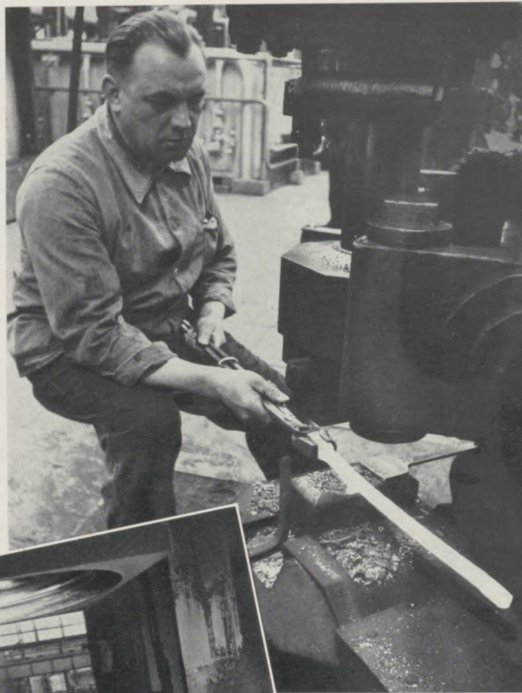
Oben: Das Aus Schmieden unserer Edelstähle bis zu den geringsten Abmessungen wird nur von erfahrenen Fachkräften ausgeführt; Werk Werderhöl.
