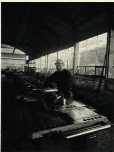
▲ Frankfurt liefert Betonstahl fix und fertig geschnitten und gebogen — an der Biegemaschine Stephan Hersak
