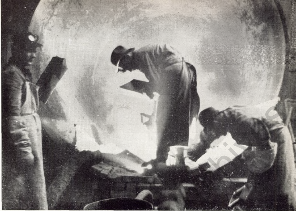
Warmschweißen einer beschädigten Schlackenpfanne von 14 Tonnen Gewicht. Die Pfanne faßt elf Kubikmeter Schlacke. Man erkennt deutlich das Schweißgerät in der Hand des Schweißers (Mitte) mit der langen Elektrode
