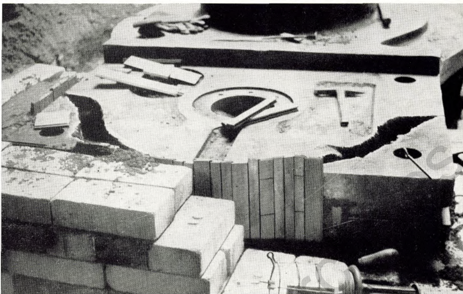
Ein gebrochener Preßzylinder von elf Tonnen Gewicht wird zum Warmschweißen vorbereitet. Deutlich sieht man die abgebrochenen Ecken und die breiten Fugen. Das gesamte Gußstück wird in der Grube eingeformt, die seitlichen Öffnungen der Bruchstelle mit Formkohle, die ganze Grube mit feuerfesten Steinen
