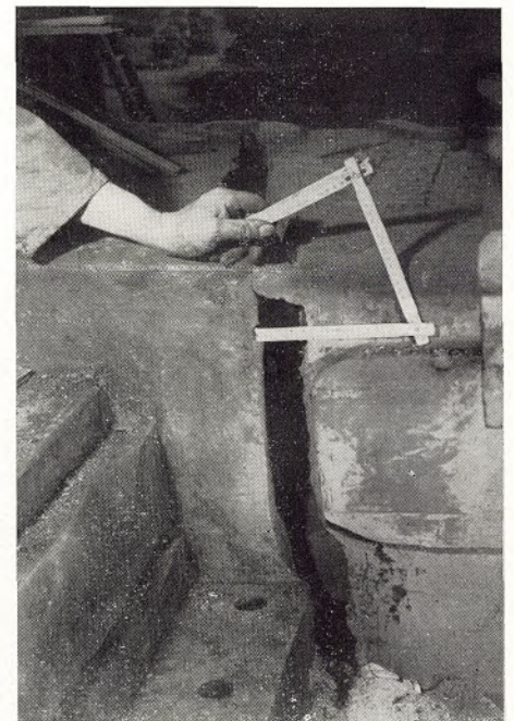
Fast sechzig Millimeter breit war die Fuge, die für das Zusammenschweißen der Scheren-Bruchstücke freigelegt werden mußte
