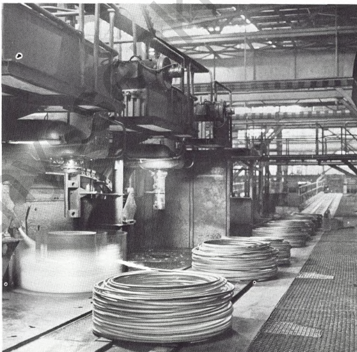
Automatische Draht-Stab-Stahl-Straße im Werk Witten der TEW.
