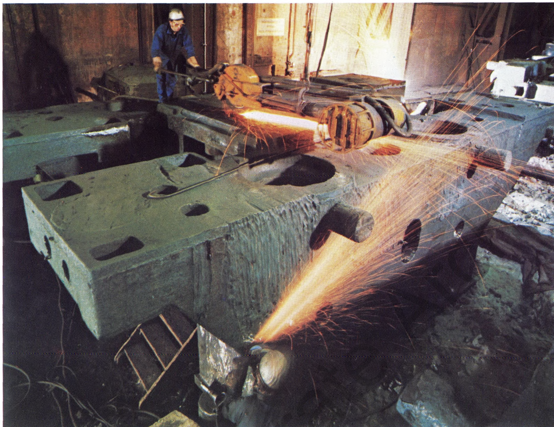
Zwei Putzer sorgen für „Oberflächenkosmetik“ am Pressentisch der 12 000-Tonnen-Presse: Das mächtige Pressenteil steht zur Bearbeitung auf dem Kopf.
