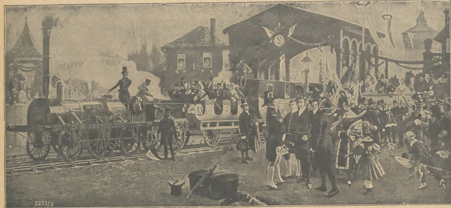
Abb. 1: Erste deutsche Eisenbahn Nürnberg-Fürth. Der Zug besteht aus der Lokomotive „Adler“ und neun Personenwagen. Zuglänge: fünfzig Meter; Geschwindigkeit: dreißig Kilometer je Stunde; Leistung der Lokomotive: 40 PS (Pferdestärken)
