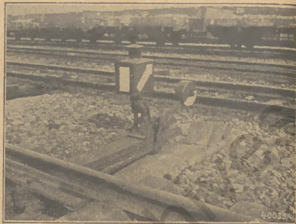
Weichenumlegeblock mit Laternen signal
