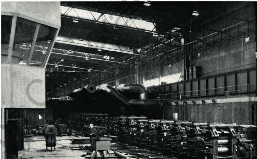
Blick auf die Straße. Ganz hinten der Stoßofen, dann — nach vorn — die Mittelstraße in Richtung Fertigstraße, links vorn die Hauptsteuerbühne
