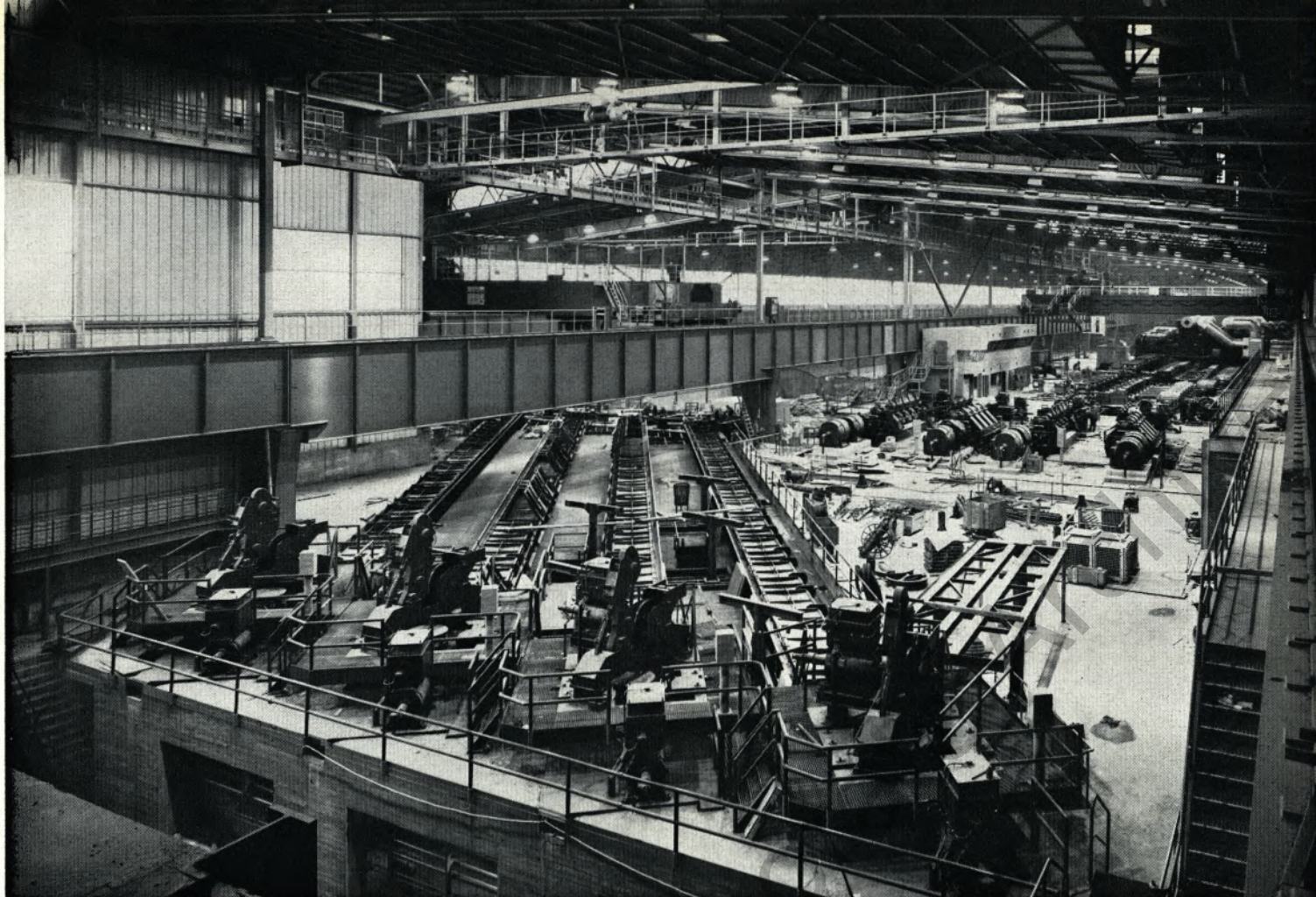
Unser Bild oben zeigt: Blick auf die Drahtstraße IV. Ganz hinten rechts sehen wir den Stoßofen, dann (in der Reihenfolge des Materialflusses) die Vor-, Mittel- und Fertigstraße, dann müßte die bei Redaktionsschluß noch nicht montierte Wasserkühlstrecke folgen, im Vordergrund die Stelmere-Bänder (kontrollierte Luftkühlung), die unter der Kranbahn hindurch zu der Bundstation führen
