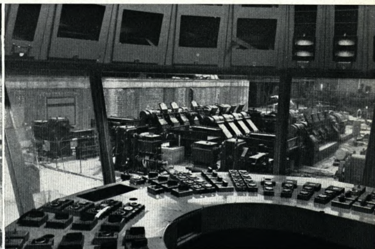
Bild unten: So sieht der Steuermann von der Hauptsteuerbühne aus die Drahtstraße. Links: Blick in Richtung Stoßöfen, rechts: Blick in Richtung Fertigstraße
