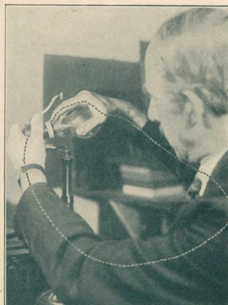
Unvorschriftsmäßige Fassung einer Lampe und unvorsichtiges Einführen der Birne leitet den Strom durch den Körper.
