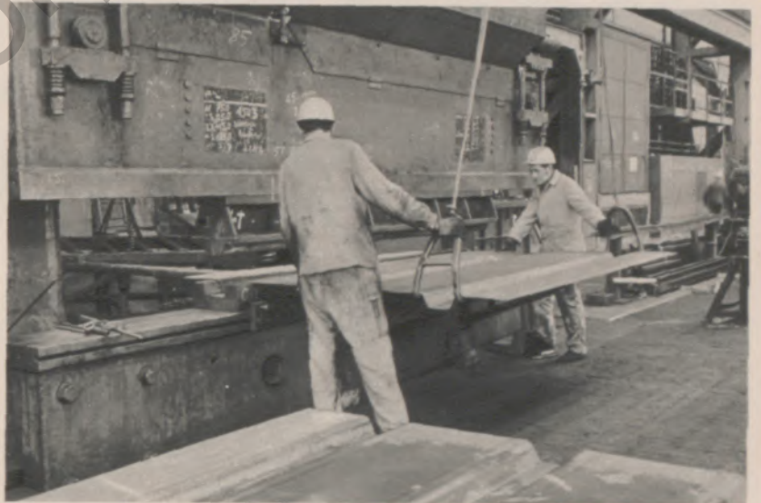
▲ Alfred Gabrych überprüft mit Hilfe einer komplizierten Schablone die fotoelektrische Abtastung der Portalbrennmaschine
