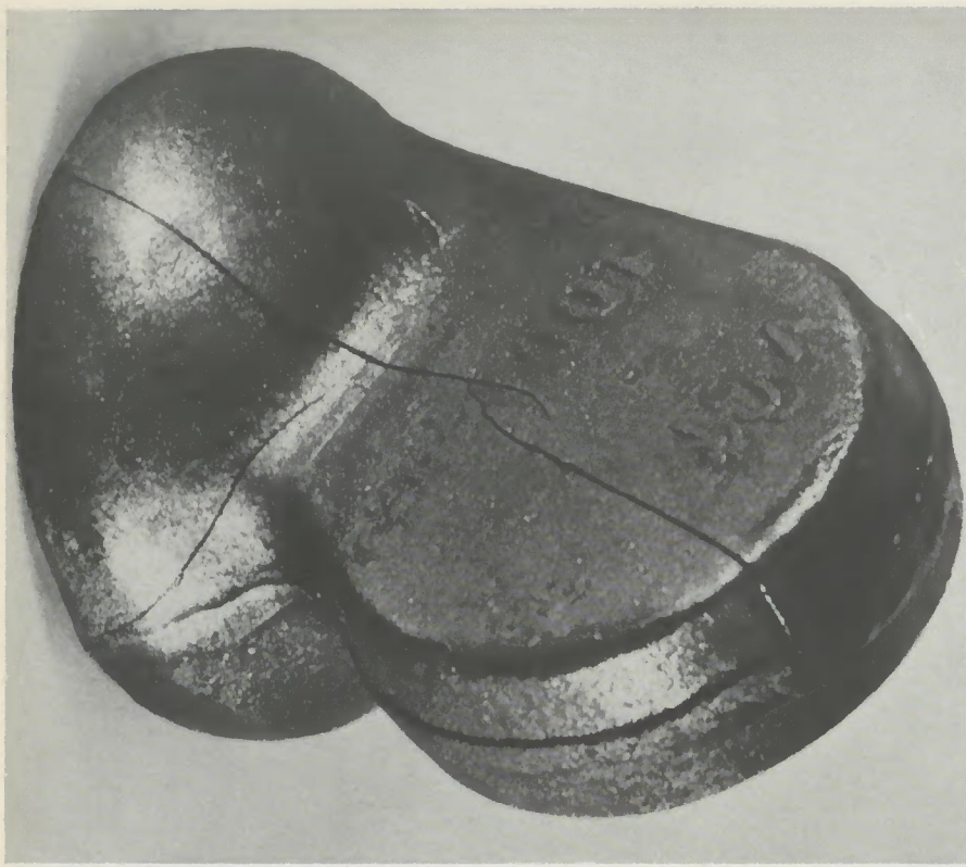
Abb. 6. Bei der magnetischen Rißprüfung sichtbar gewordene Risse
