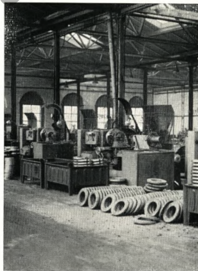
Zahlreiche moderne Maschinen übernehmen die Weiterverarbeitung des Flanschenrohlings
