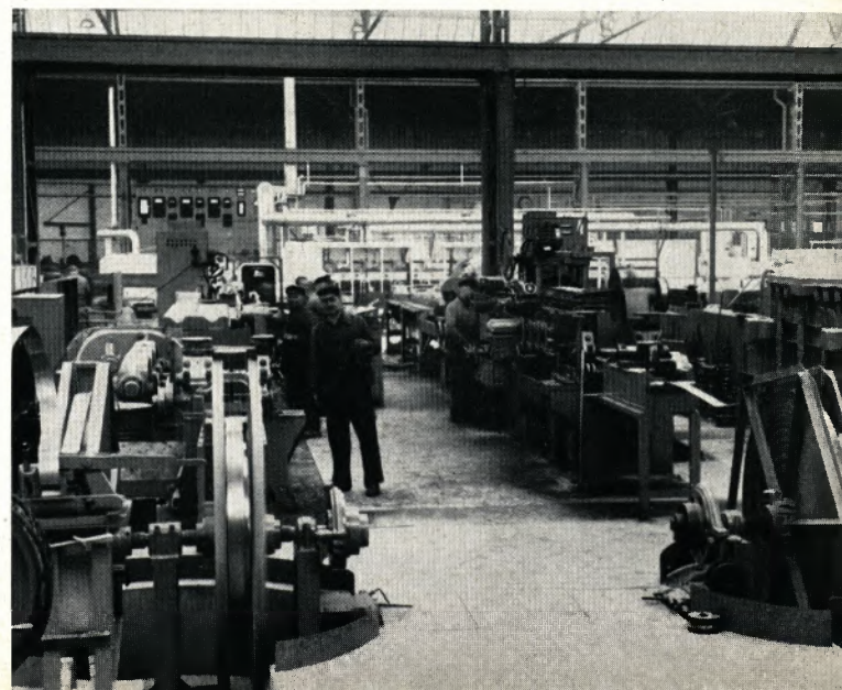
WURAG-Präzisionsstahlrohre werden auf modernen Rohrschweißmaschinen hergestellt.
