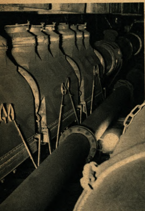
▼ Staubabsaugevorrichtung an der Zentralfüllstelle Finefrau, Kaiserstuhl-Ostfeld
