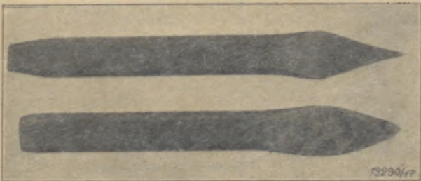
Bild 4: Facharbeit für Bauschlosser: Kreuzmeißel (schlechte und gute Ausführung)
