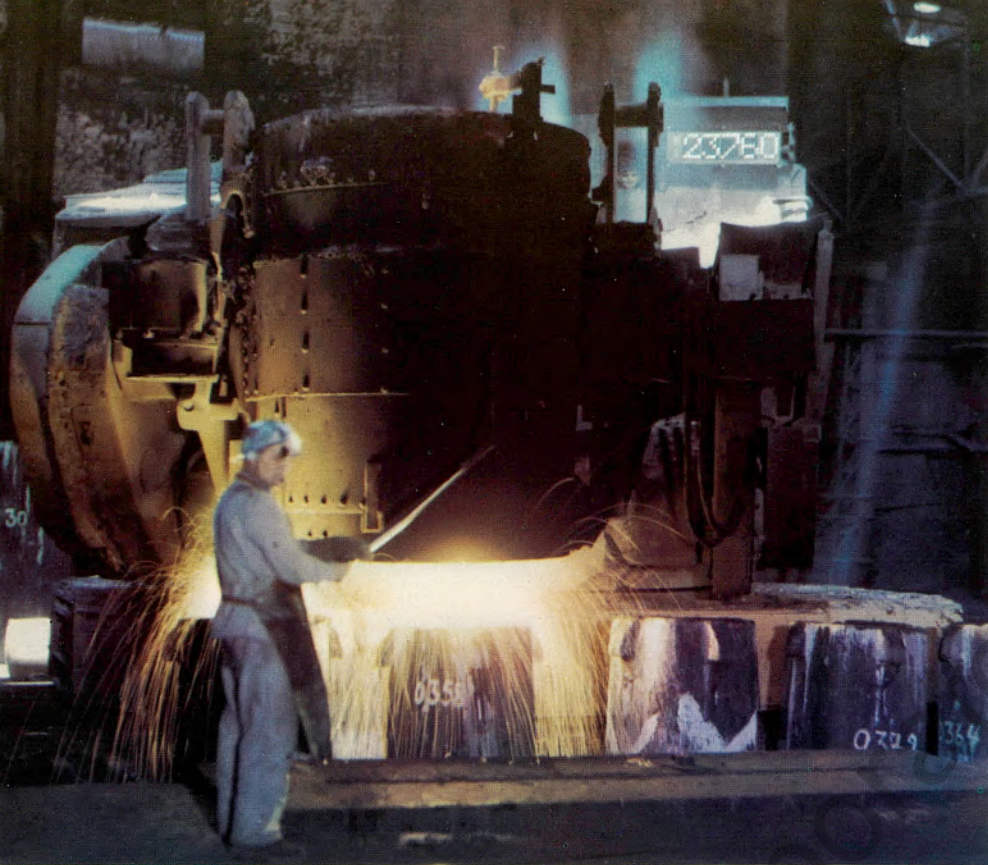
Bild 2 Gießwagen im Thomas-Stahlwerk, Dortmund, mit elektronischer Waage und digitaler Gewichtsanzeige auf einem Leuchtziffernfeld
